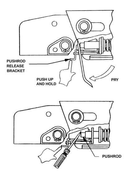
FIGURE 16 STROKING PUSHROD TO BLEED BRAKES
